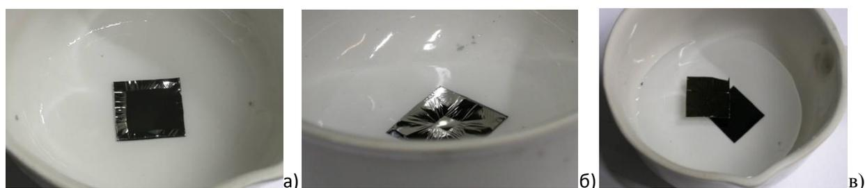
**Рис. 2.3.** Процесс отделения плёнки от подложки (а, б –травление подслоя от краёв квадратной подложки к центру, в- после отделения плёнка плавает на поверхности жидкости, а кремниевая подложка лежит на дне чашки).
