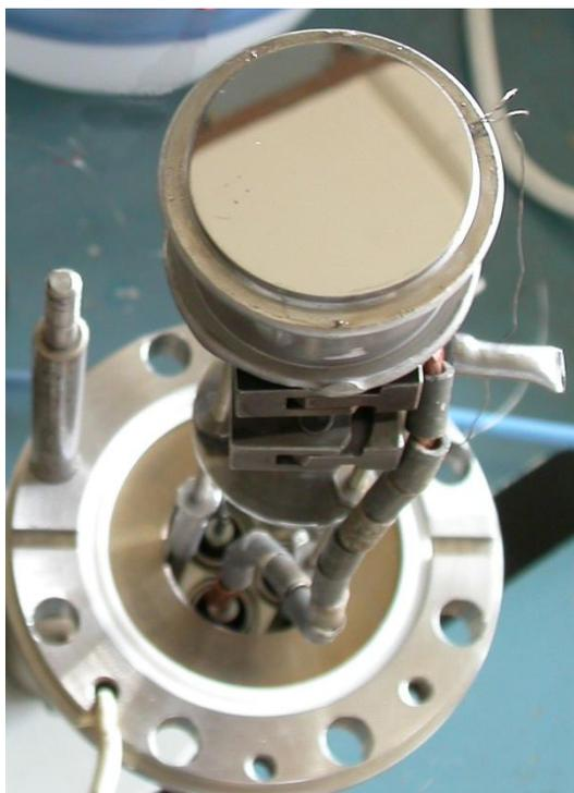
**Рис. 2.9.** Фотография прикрепленного к входному фланцу электронагревателя с полированной поверхностью, на которую напылена исследуемая плёнка.
