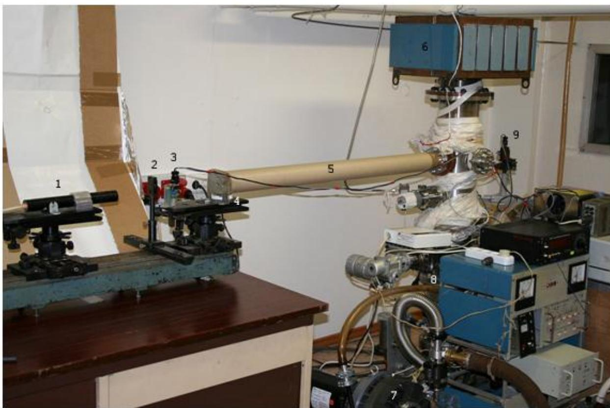
**Рис. 2.7.** Фотография стенда для температурных и вакуумных испытаний фильтров. Слева направо: He-Ne лазер (1), диафрагма (2), детектор-монитор с усилителем (3), делительная стеклянная пластинка (4), светоизолирующий тубус (5), вакуумная камера с насосами (сверху – магниторазрядный (6), внизу – форвакуумный (7), под вакуумной камерой – турбомолекулярный (8)); справа от вакуумной камеры – детектор с усилителем (9).
