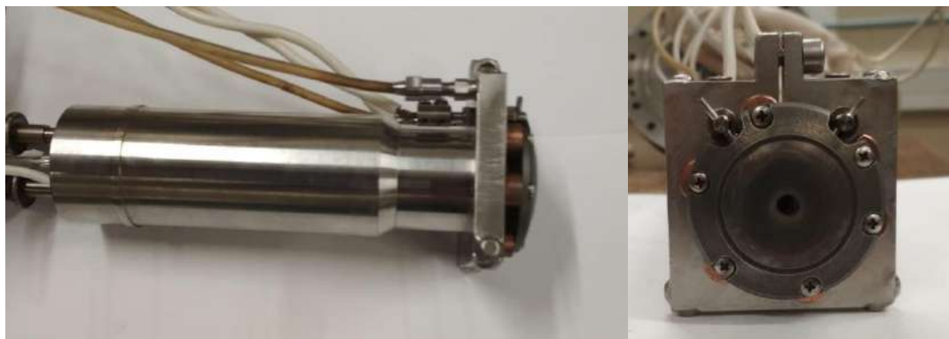
Рис.4.13. Схема и фото крепления водо-охлаждаемого кожуха (1-Ионный источник; 2-Нить накала катода нейтрализатора; 3-фокусирующая ионно-оптическая система; 4-водо-охлаждаемый кожух (нержав. сталь); 5-керамические изоляторы; 6- молибденовый экран; 7-медные проставки).
