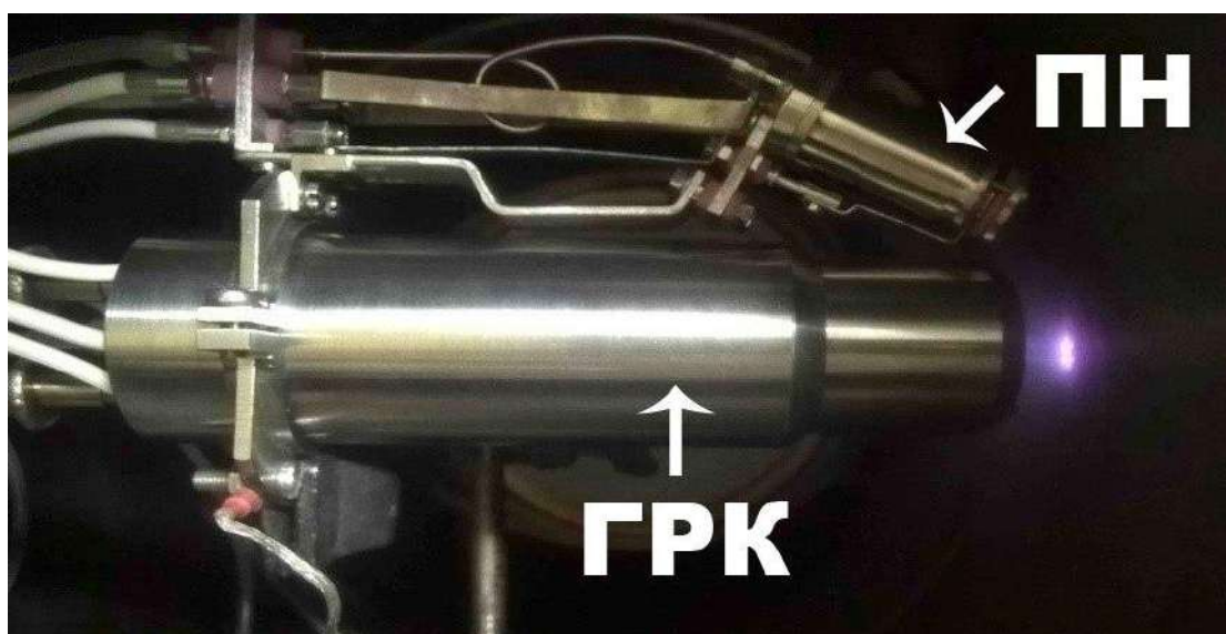
Рис. 4.4. Схема и фото источника ускоренных ионов КЛАН-10М с плазменным нейтрализатором.
