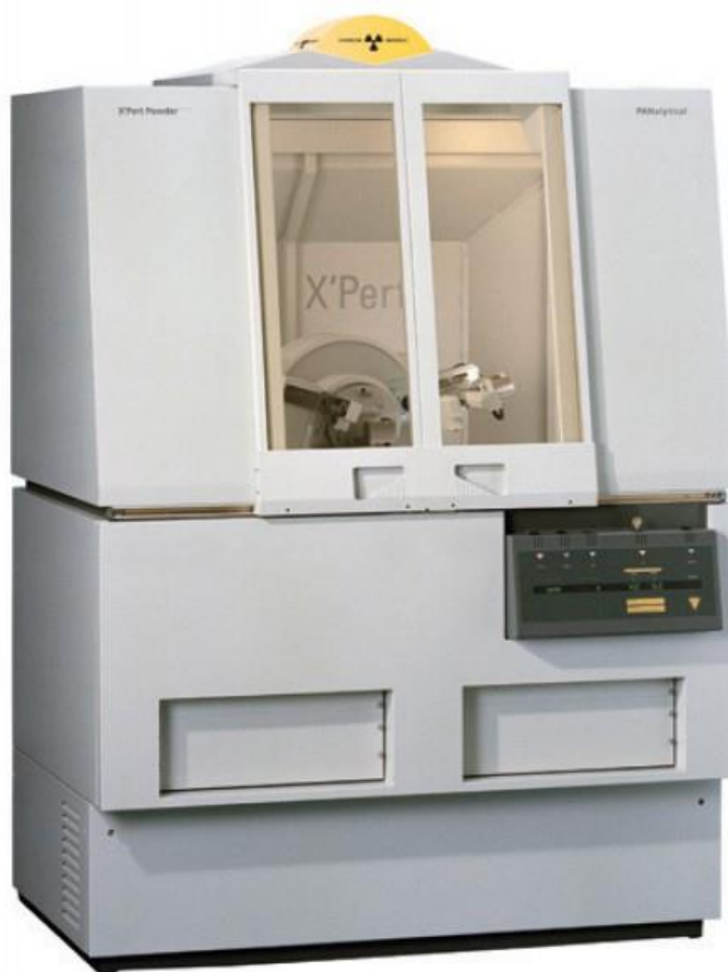
Рис. 2.5. Внешний вид дифрактометра Panalytical X'Pert PRO.
