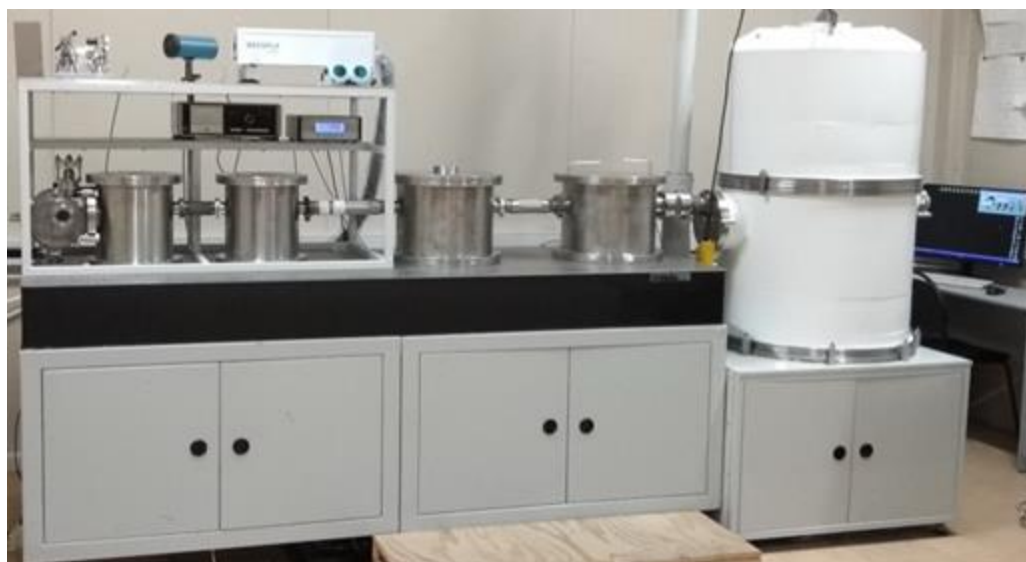
Рис. 2.14. Внешний вид рефлектометра с лазерно-плазменным источником и монохроматором Черни-Тернера.
